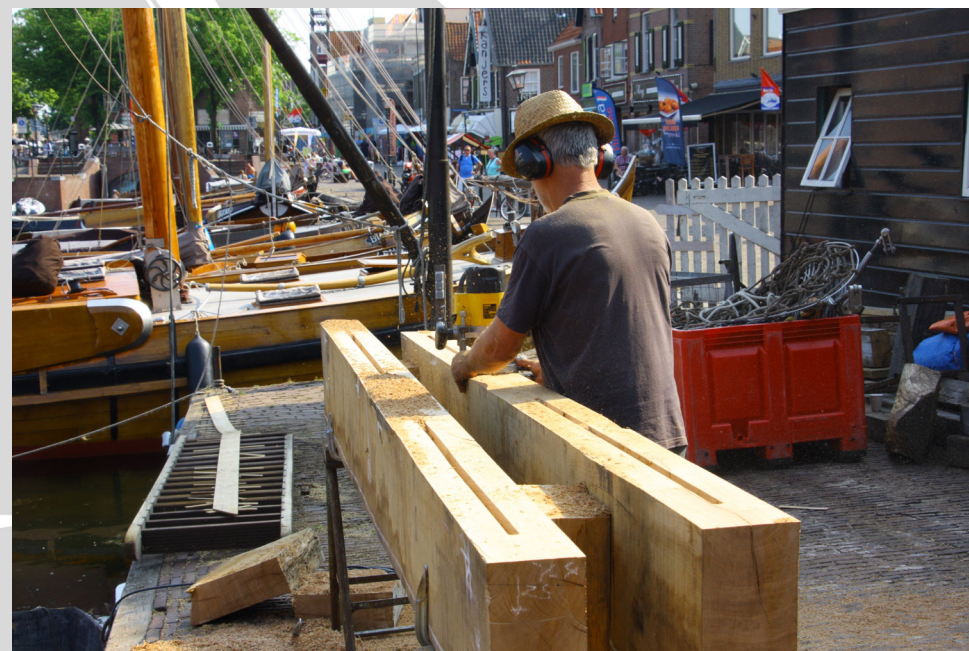
De twee helften van de mastbank, met gleuf voor de veer
